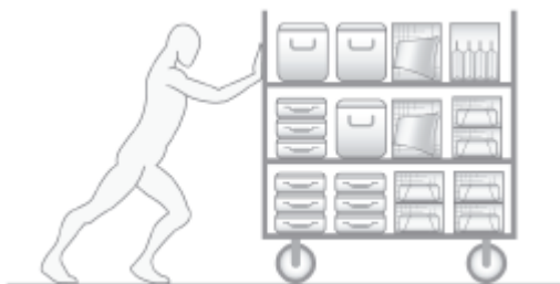
Obr. 34: Vozík s obsahem 12 STJ může vážit o málo více než 200 kg.
