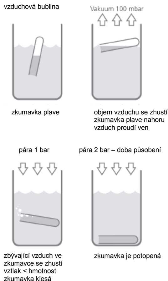
Obr. 58: Klesání zkumavky se vzduchovými bublinkami v důsledku předvakua
