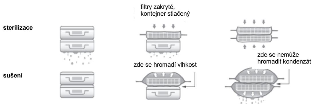
Obr. 41: Výskyt kondenzátu během sušení
