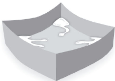
Obr. 82: Kondenzát způsobuje teplotní napětí
