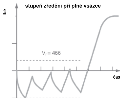
Obr. 89: Odstraňování vzduchu u časově řízeného procesu
