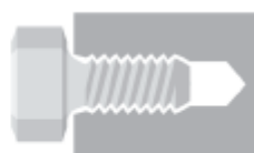
volně zašroubované šrouby do slepé díry méně obtížná sterilizace
