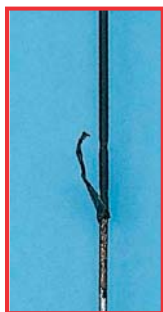
Poškozená izolace na VF nástroji
