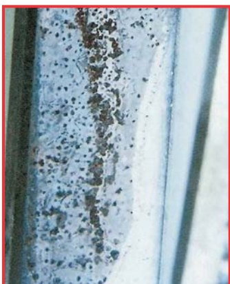
Usazeniny leptavého prostředku obsahujícího chloridy na nástroji
