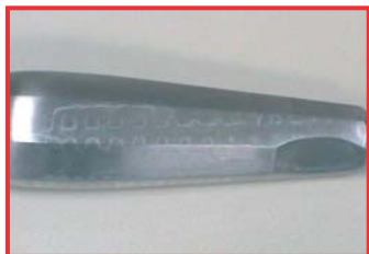
Zanesení zbytky dezinfekčního prostředku při nedostatečném propláchnutí
