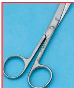
Nůžky s důlkovou korozi
