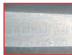
Povrch nástroje s otiskem perforace síta
