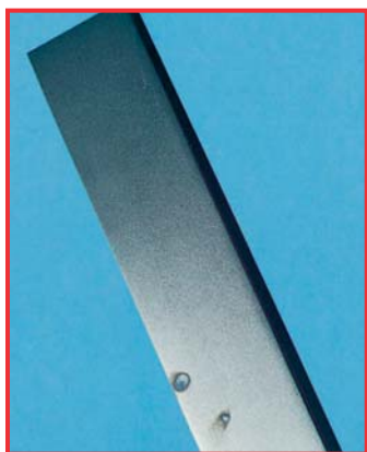
Napadnutí dlátka korozí
