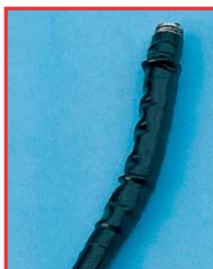
Zpuchření na hadici fibroskopu při použití nesprávné konzervační látky
