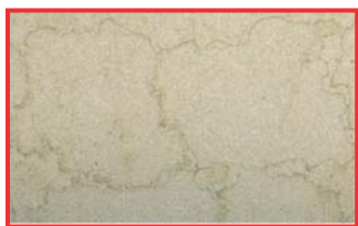
Mramorování způsobené nečistotami v parním kondenzátu
