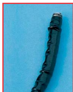
Nabobtnání na distálním konci fibroskopu
