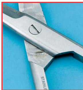
Koroze z oděru, způsobená neodpovídajícím promazáním olejem
