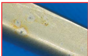
Chloridem způsobená důlková koroze na nástroji
