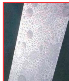
Povrch nástroje se skvrnami ve tvaru kapek
