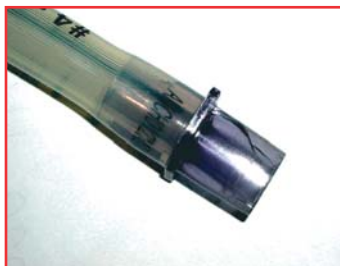
Trhlínka způsobená pnutím
