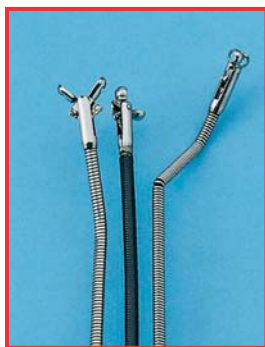
Násilně poškozené bioptické kleště
