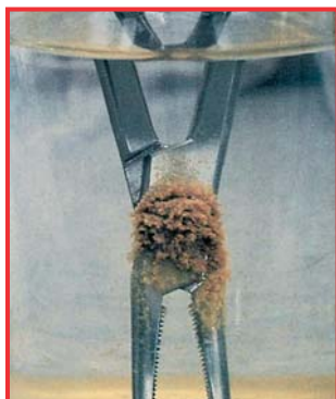
Vytvoření rzi při vícehodinovém ponoření do fyziologického roztoku
