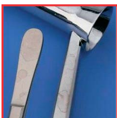
Skvrny způsobené vysokým obsahem solí v proplachovací vodě
